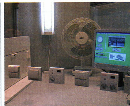
Die Enocean-Technologie setzt auf batterie-lose Funktechnologie mit Piezo-Energie
